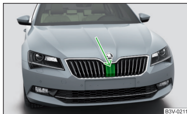
Obr. 268 Umístění radarového snímače
