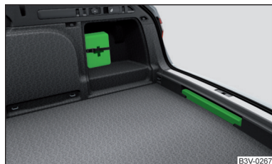
Obr. 332 Umístění lékárničky a výstražného trojúhelníku: varianta 2
