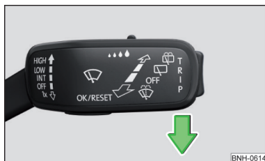
Obr. 357 Nastavení servisní polohy stěračů
