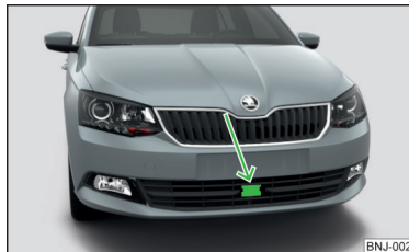
Obr. 220 Umístění radarového snímače
