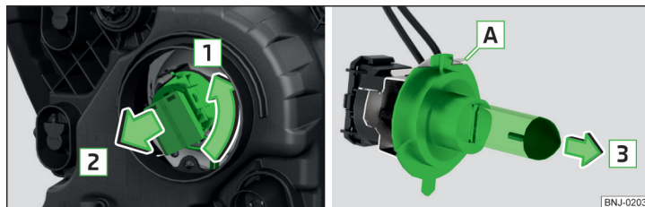
Obr. 308 Výměna žárovky dálkového světla
