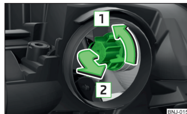
Obr. 306 Výměna žárovky předního směrového světla
