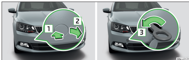
Obr. 285 Vyjmutí krytky / Montáž vlečného oka
